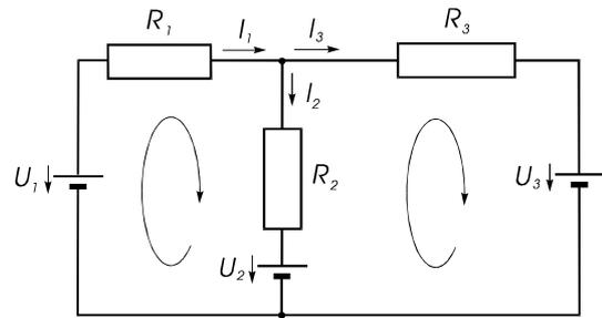
Lösung: Nach der Bezeichnung von Strömen, Spannungen und Angabe des jeweiligen Umlaufsinn ergibt die Anwendung der Knoten- und der Maschenregel folgendes Gleichungssystem:
