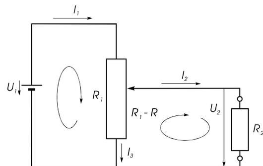
*Lösung:* In die Schaltung laut Abb. 2.6 werden Ströme und Spannungen eingetragen und der Umlaufsinn in jeder Masche gekennzeichnet.
