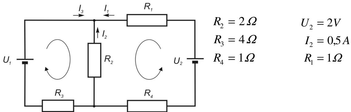
*Ergebnis:*  $U_1 = -9V$ , d.h. die Spannungsquelle  $U_1$  muss umgepolt werden!
