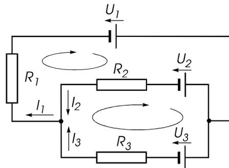
Lösung: Nach der Bezeichnung von Strömen und Festlegung der Umlaufrichtungen erhalten wir wieder durch Anwendung von Knoten- und Maschenregeln das Gleichungssystem für das Netzwerk:
