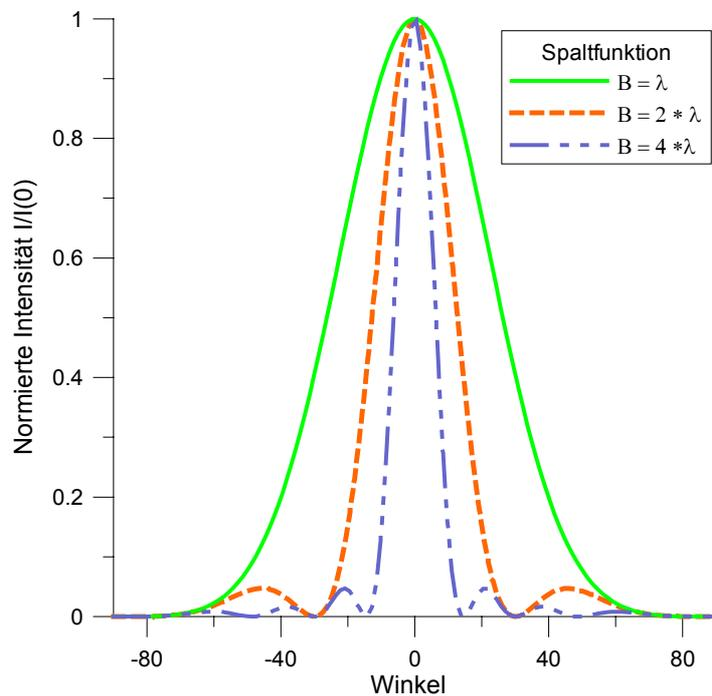
Abbildung: Normierte Intensität in Abhängigkeit von der Spaltbreite B
