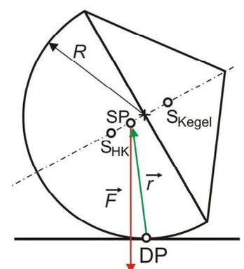
halb der Halbkugel liegt. Das Drehmoment  $\vec{M} = \vec{r} \times \vec{F}$  um den Drehpunkt DP infolge der Gewichtskraft  $\vec{F}$  ist linksdrehend, also aufrichtend orientiert. Bei kleiner werdendem Abstand von SP zur Kegelgrundfläche nimmt dieses ab und verschwindet, wenn SP in dieser Fläche liegt. Dann sind beide Vektoren  $\vec{r}$  und  $\vec{F}$  antiparallel und das Kreuzprodukt zwischen ihnen ist Null – indifferentes Gleichgewicht!
