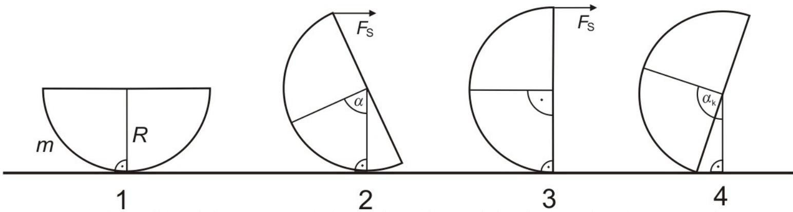
3.) Eine Halbkugel der Masse  $m$  mit dem Radius  $R$  liegt auf einer horizontalen Ebene. Unter dem Einfluss der Schwerkraft gibt es eine stabile und eine labile Gleichgewichtslage (Abb. 1 und 4). Weitere stabile Positionen werden durch eine zusätzliche, horizontal gerichtete Kraft  $F_s$  ermöglicht mit einem Angriffspunkt an der Kante der Halbkugel (Abb. 2 und 3).
