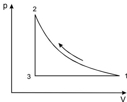
5.) Mit einem idealen Gas wird ein linksläufiger Kreisprozess durchgeführt (s. Skizze).
