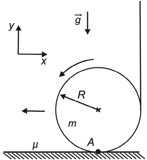
j) Zeichnen Sie die an der Masse angreifenden Kräfte in die Skizze ein und benennen Sie diese mit einem Symbol sowie Substantiv.
